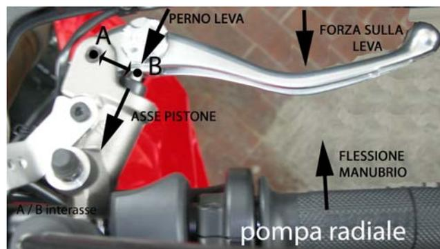
vantaggio per le pompe radiali la possibilità per l'utente di variare questo interasse per scegliere una frenata più pronta o più modulabile, come sull'ultima pompa Brembo, appunto regolabile 19x18 o 19x20 (dove 19 è il diametro del pistone della pompa, 18 (più pronta) e 20 (più modulabile) la distanza tra il fulcro e l'asse premente sul pistone della pompa)
