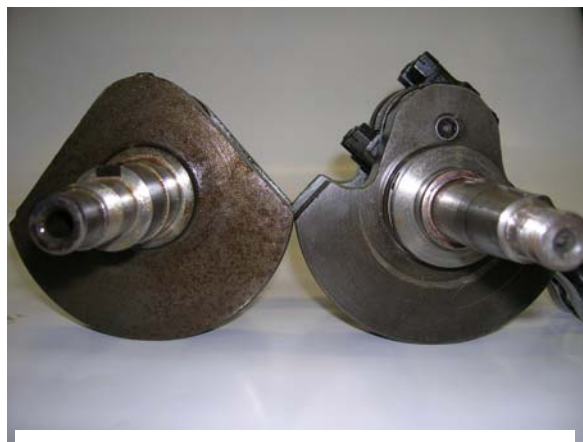
Fig. 2 Confronto tra un albero motore 350 pre-83 (sn) e un altro dello stesso tipo ma con contrappesi modificati a mannaia
